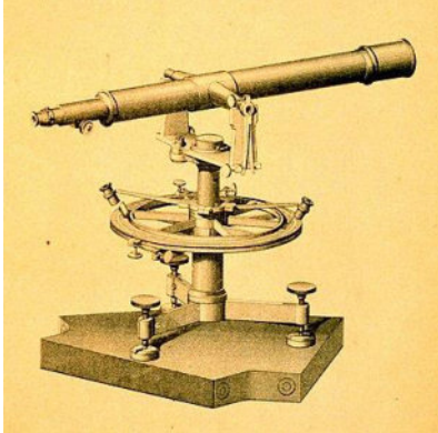
Figuur 5 Repetitie cirkel van Borda, vernoemd naar de bedenker Jean-Charles de Borda en gemaakt door de Franse instrumentenmaker Etienne Lenoir
