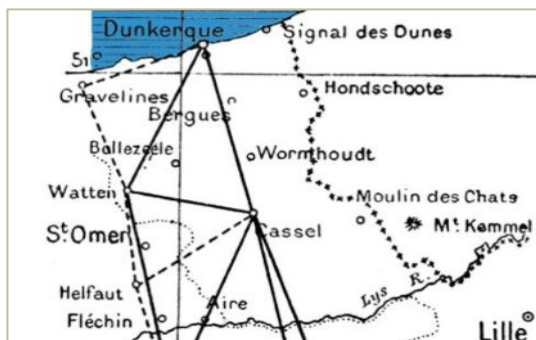
Figuur 3 Een deel van een originele kaart van de uitgevoerde driehoeksmetingen door Delambre-Méchain. De streeplijnen zijn de controlemetingen die als secundaire metingen werden uitgevoerd.
